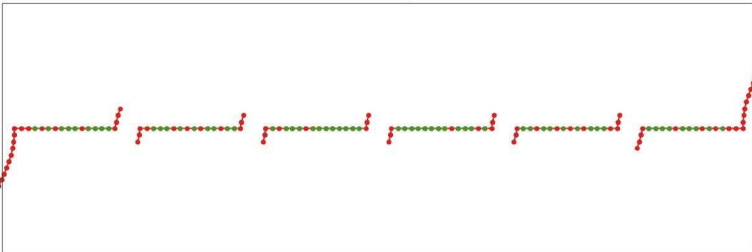
Abb. 5.106: Rißbilder bei Modellrechnungen mit i=+45^\circ , -75^\circ , -30^\circ bzw. 0^\circ rote Rißabschnitte werden auseinander gezogen grüne Rißabschnitte weisen Scherverschiebungen auf
