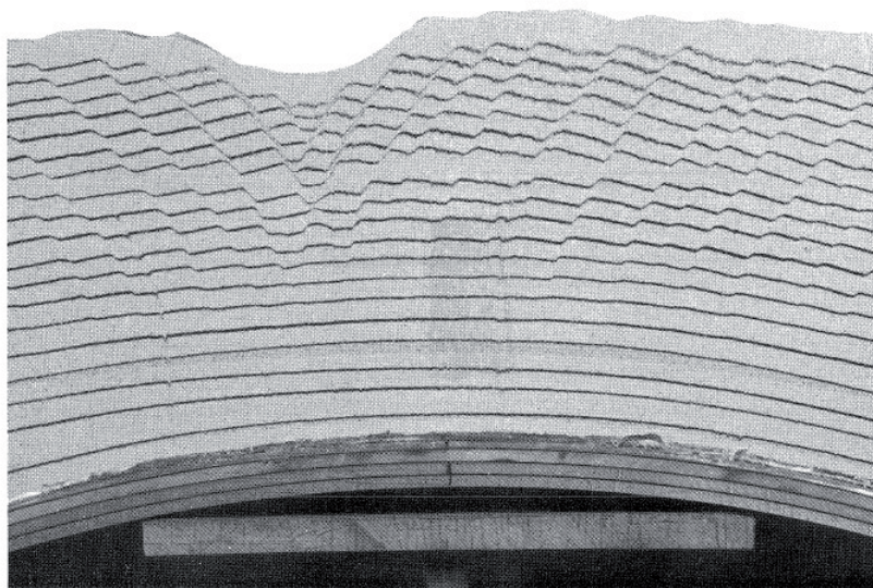
Abbildung 2.15.: Parallele Scherbänder in dichtem Sand infolge Aufbiegung der Unterlage, Experiment von Mandl (1984), Vermeer & de Borst (1984)
